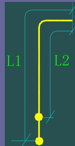
2b25: L2=层高-（本层楼面距接头距离+本层相邻纵筋交错距离）-梁高+柱头
