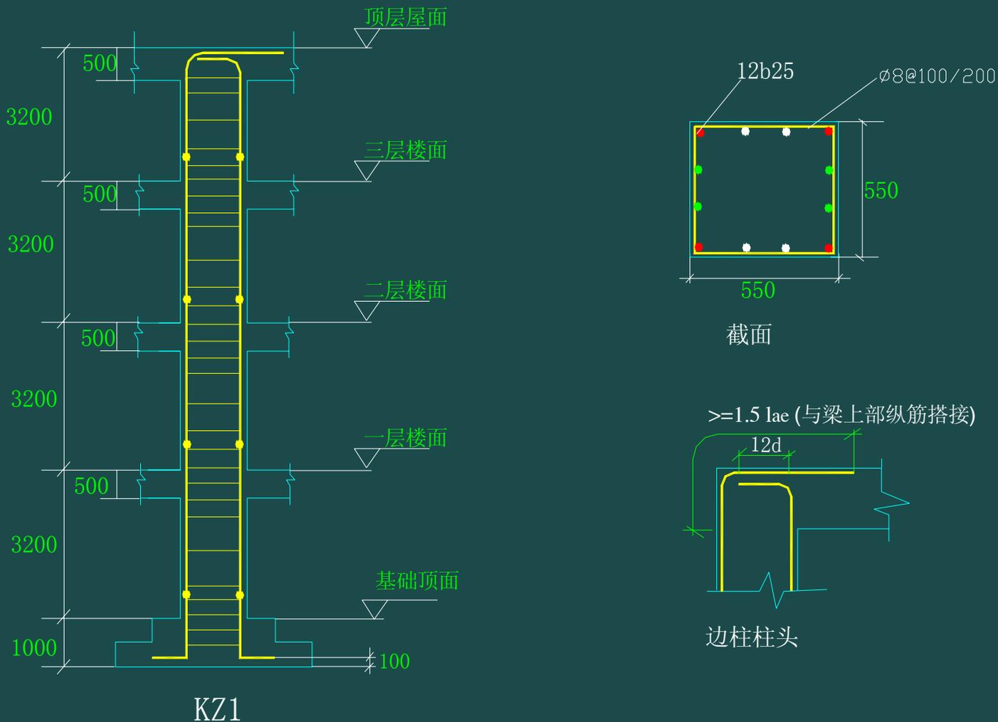
注:KZ1为边柱, C25砼, 三级抗震,采用焊接连接, 主筋在基础内水平弯折为200, 基础箍筋2根, 主筋的交错位置、箍筋的加密位置及长度按“03G101-1规范”计算
