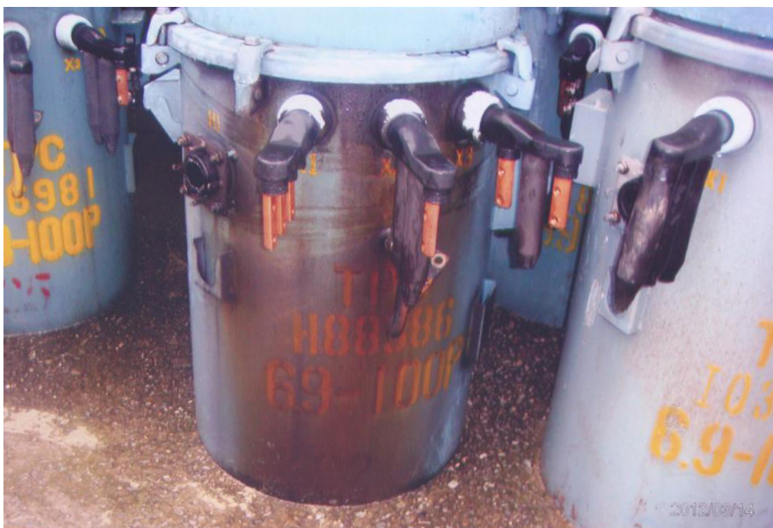
圖 3-6 變壓器絕緣油由二次套管外洩，沿箱體外側流出，油漬清楚可見。
