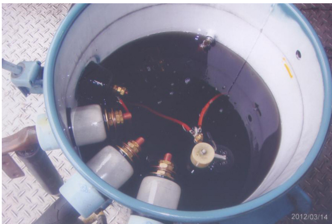
圖 3-7 變壓器漏油後，桶內油面下降，二次套管(含銅接頭)及一次套管井(含引線)均露出油面。
