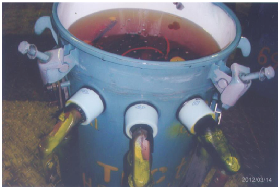
圖 3-5 變壓器一、二次繞組正常，絕緣油未劣化，但二次套管橡膠被覆有龜裂脫落情形。
