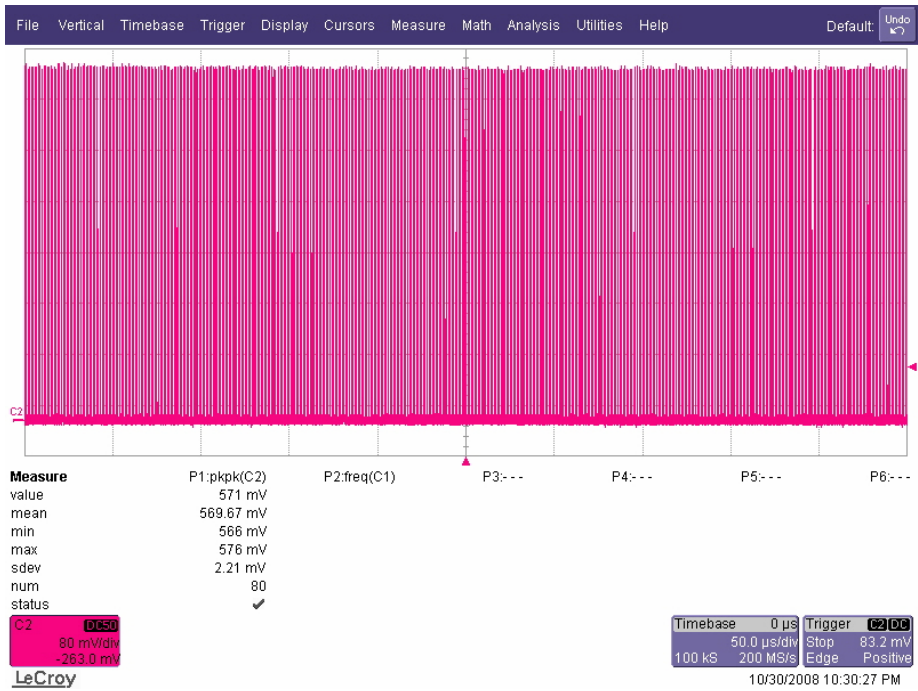
图七 不同的量程下的测试结果，608.81mV / 569.67mV
