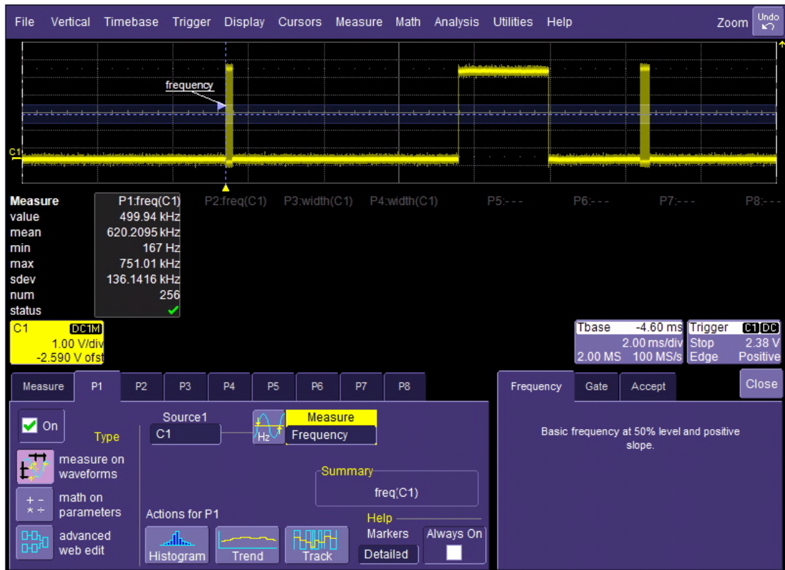
图 10 参数测量会对完整的波形进行测量计算
