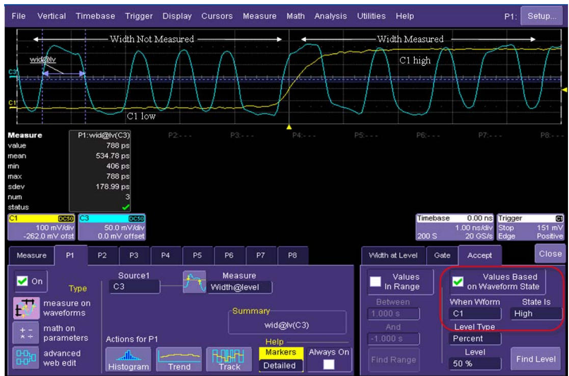
图 6 波形门限测量的设置
