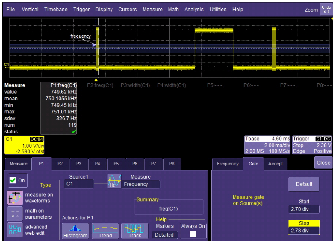
图 12 对限定范围内的波形进行参数测量
