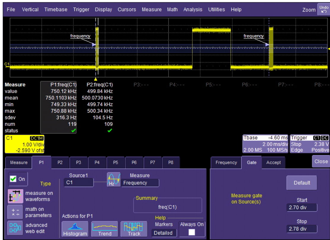
图 13 利用 Gate 功能对限定范围内的波形进行参数测量
