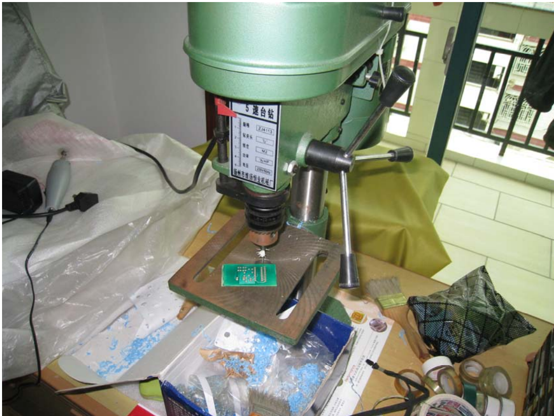
图(18) 用小电钻或台钻钻孔。对电路板不齐的边可以用电磨修整一下。
