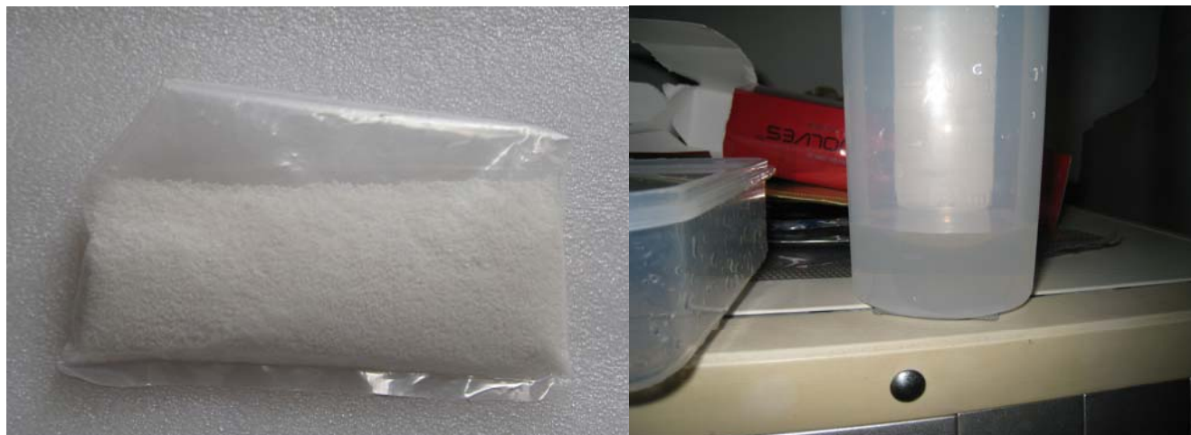
图(7) 使用显影剂和塑料量杯配制显影液
