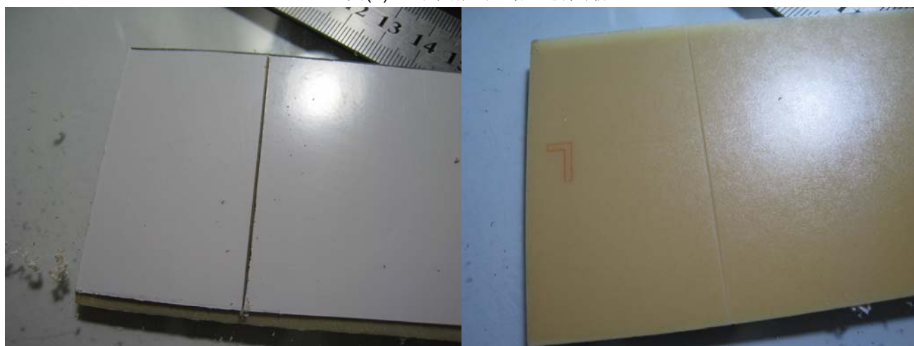
图(2) 在正反两面均拉出 0.3~0.5mm 深度的槽
