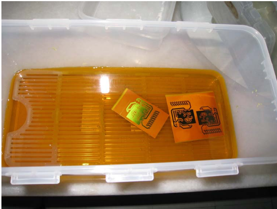
图(10) 放入三氯化铁溶液蚀刻
